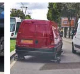
On frôle la folie : les dolly non sanglés sur l'essieu arrière se sont placés de travers durant le roulage. La voiture avance en crabe sur la voie.
