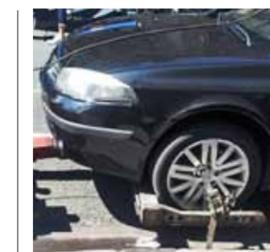
Parfois, le travail est correctement réalisé : la roue avant du véhicule enlevé est ici correctement sanglée sur le panier de levage.
